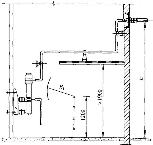
图 E.2 室内  $B_1$ 、 $E$  值校验
